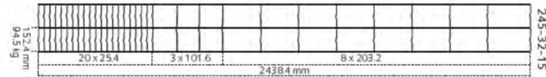
Figure 41 : Clôture grande faune à mailles progressives de type 245/32/15
