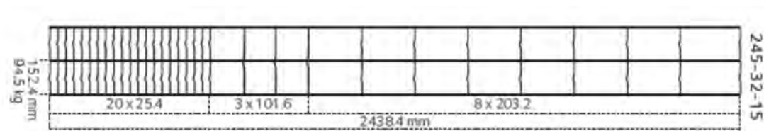
Figure 54 : Clôture grande faune à mailles progressives de type 245/32/15
