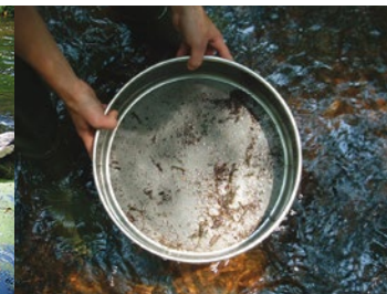
Prélèvement de macro-invertébrés - Tamis maille 500 µm
